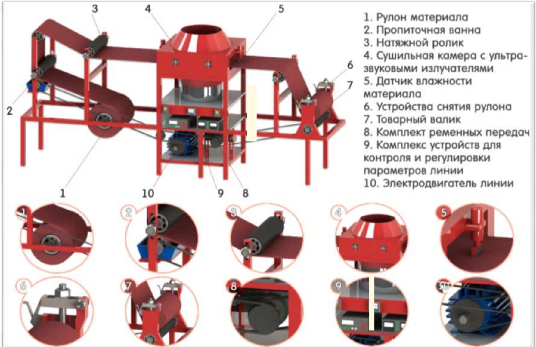
*Энергоэффективная технология формирования композиционных текстильных материалов с использованием ультразвукового излучения*
