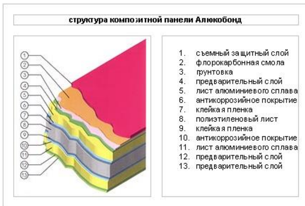
Рисунок 22 – Структура композитной панели Алюкобонд
